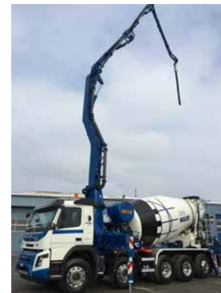
Malaxeur pompe 28 mètres
